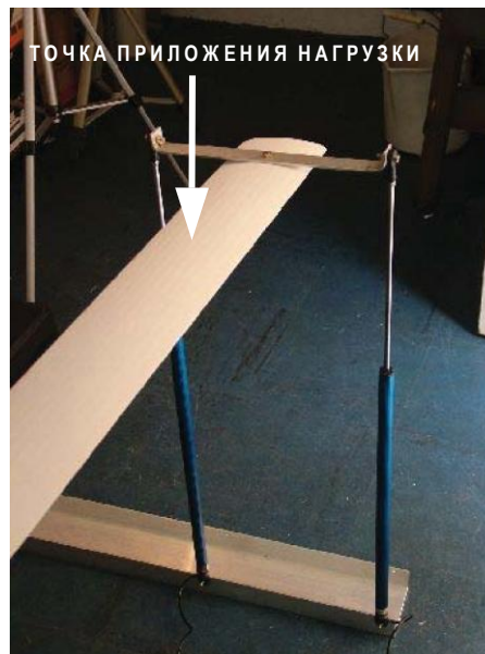
Рисунок 5. Сигнальный дорожный столбик Delnorth СТИЛФЛЕКС, статические испытания на изгиб, показаны направление приложения нагрузки и два потенциометра
